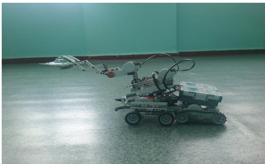
Робот состоит из подвижного рычага, имеющего три степени свободы, гусенично - колесной платформы, позволяющей передвигаться по различным покрытиям и двух блоков NXT, один из которых отвечает за передвижение, а другой за управление стрелой. И пяти сервомоторов, два из которых отвечают за движение, а три за поворот стрелы.
